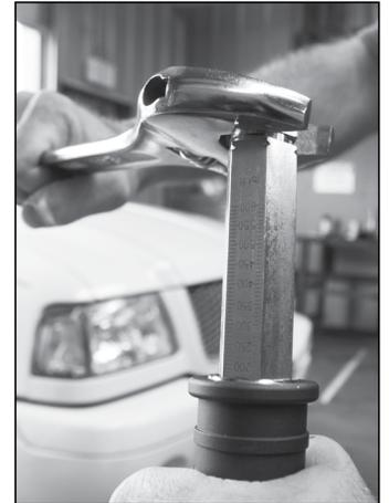
**NOTA:** La barra de ajuste deberá ajustarse de nuevo a 0 después de cada uso con el fin de evitar la pérdida de calibrado y también para, a la larga, extender la vida útil de su torquímetro.
