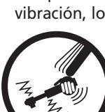
• Las herramientas que funcionan con aire pueden vibrar durante el uso. La vibración, los movimientos repetitivos o las posiciones incómodas durante períodos prolongados pueden ser dañinos a sus manos y brazos. Interrumpa el uso de la herramienta si sobreviene una incomodidad, una sensación de cosquilleo o un dolor. Solicite una opinión médica antes de volver a proceder con el uso.
