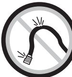
causar lesiones graves. Verifique siempre para detectar mangas gastadas, usadas o flojas y reemplacel as inmediatamente. No utilice los acoplamientos de conexión rápida con esta herramienta. Vea las instrucciones para conocer el modo de instalación adecuado.
