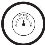
psig (6.2 bar), utilizando una manguera de aire con un diámetro de 5/16".
