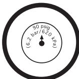
• Pour assurer un fonctionnement sécuritaire, un rendement optimal et la durabilité des pièces, utilisez une pression d'air maximale de 90 lb/po<sup>2</sup>, 6,2 bar et un boyau d'un diamètre de 5/16 po.
