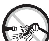
de látilo pueden ocasionar heridas serias. Siempre revise las mangueras y herrajes por daños, deshilachas o solturas, y si es necesario, repóngalos inmediatamente. No opere ninguna herramienta dañada ni deteriorada. No use los acoplamientos de separación rápida con la herramienta. Vea las instrucciones para la instalación correcta.
