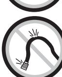
Caso omiso en hacerlo podría ocasionar alguna lesión. Las mangueras de látigo pueden ocasionar heridas serias. Siempre revise las mangueras y herrajes por daños, deshilachas o solturas, y si es necesario, repóngalos inmediatamente. No opere ninguna herramienta dañada ni deteriorada. No use los acoplamientos de separación rápida con la herramienta. Vea las instrucciones para la instalación correcta.
