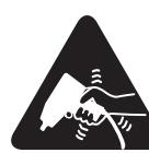
Les outils pneumatiques peuvent vibrer pendant l'utilisation. Une exposition prolongée aux vibrations, les mouvements répétitifs, ou une posture inconfortable lors de l'utilisation peuvent être nuisibles pour vos mains et vos bras. Arrêtez d'utiliser l'outil en cas d'inconfort ou si vous ressentez des picotements ou de la douleur. Consultez un médecin avant de recommencer à utiliser l'outil.
