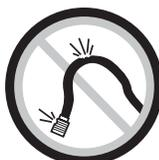
souples peuvent causer de graves blessures. Vérifiez toujours les boyaux et les raccords et remplacez-les s'ils sont endommagés, fissurés ou lâches. Évitez d'utiliser un outil endommagé ou usé. Évitez d'utiliser des raccords rapides avec cet outil. Pour installer correctement l'outil, consulter les directives.
