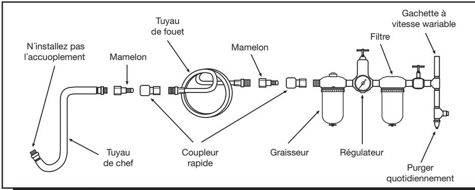
Les outils de cette catégorie fonctionnent avec un large éventail de pressions d'air. Nous recommandons une pression d'air à l'entrée de 90 lb/po<sup>2</sup>. Une faible pression (moins de 90 lb/po<sup>2</sup> ou de 6,2 bar) réduit la vitesse et le rendement de tous les outils pneumatiques. Une pression élevée (plus de 115 lb/po<sup>2</sup> ou 8,0 bar) excédant la puissance nominale de l'outil raccourcit sa durée de vie et peut causer des blessures.
