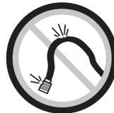
de látigo pueden ocasionar heridas serias. Siempre revise las mangueras y herrajes por daños, deshilachas o solturas, y si es necesario, repóngalos inmediatamente. No opere ninguna herramienta dañada ni deteriorada. No use los acoplamientos de separación rápida con la herramienta. Vea las instrucciones para la instalación correcta.
