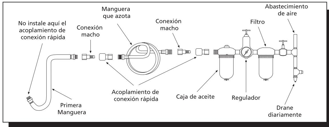
Las herramientas de esta categoría operan bajo una amplia gama de presiones de aire. Nosotros recomendamos que la presión de aire mida 90 PSI en el punto de ventila de admisión de aire, mientras la herramienta esté en uso. La presión baja (menos de las 90 psig/6.2 bar) reduce la velocidad y potencia de las herramientas neumáticas. La presión alta (arriba de las 115 psig/8.0 bar) excede la capacidad nominal de
