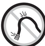
Vérifiez toujours les boyaux et les raccords et remplacez-les s'ils sont endommagés, fissurés ou lâches. Évitez d'utiliser un outil endommagé ou usé. Évitez d'utiliser des raccords rapides avec cet outil. Pour installer correctement l'outil, consulter les directives.
