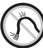
ocasionar heridas serias. Siempre revise las mangueras y herrajes por daños, deshilachas o solturas, y si es necesario, repóngalos inmediatamente. No opere ninguna herramienta dañada ni deteriorada. No use los acoplamientos de separación rápida con la herramienta. Vea las instrucciones para la instalación correcta.
