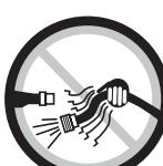
ou de faire l'entretien de l'outil, assurez-vous de toujours fermer la source d'alimentation en air, de purger l'air du boyau et de débrancher l'outil de sa source d'alimentation. Une négligence sur ce plan pourrait causer des blessures. Les tuyaux souples peuvent causer de graves blessures.
