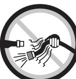
hacia usted ni a otros. Siempre apague la alimentación de aire, vacíe toda la presión de aire de la manguera y desconecte la herramienta del suministro de aire antes de instalar, quitar o ajustar cualquier pieza o accesorio de esta herramienta, o antes de realizar cualquier mantenimiento de ella. Caso omiso en hacerlo podría ocasionar alguna lesión. Las mangueras de látigo pueden
