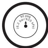
presión máxima de 90 psig (6.2 bar), utilizando una manguera de aire con un diámetro de 1/2"
