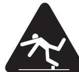
Un deslizamiento, una zancadilla y/o una caída durante el funcionamiento de las herramientas con aire pueden ser causas importantes de lesiones graves o de la muerte. Asegúrese que no haya un excedente de manguera sobre la superficie donde esté caminando o trabajando.
