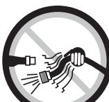
hacia usted ni a otros. Siempre apague la alimentación de aire, vacíe toda la presión de aire de la manguera y desconecte la herramienta del suministro de aire antes de instalar, quitar o ajustar cualquier pieza o accesorio de esta herramienta, o antes de realizar cualquier mantenimiento de ella. Caso omiso en hacerlo podría ocasionar alguna lesión. Las mangueras
