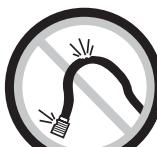
de látigo pueden ocasionar heridas serias. Siempre revise las mangueras y herrajes por daños, deshilachas o solturas, y si es necesario, repóngalos inmediatamente. No opere ninguna herramienta dañada ni deteriorada. No use los acoplamientos de separación rápida con la herramienta. Vea las instrucciones para la instalación correcta.
