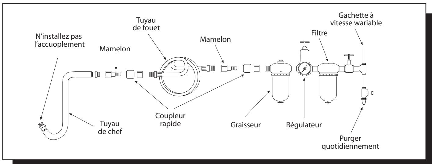
Les outils de cette catégorie fonctionnent avec un large éventail de pressions d'air. Nous recommandons une pression d'air à l'entrée de 90 lb/po<sup>2</sup>. Une faible pression (moins de 90 lb/po<sup>2</sup> ou de 6,2 bar) réduit la vitesse et le rendement de tous les outils pneumatiques. Une pression élevée (plus de 115 lib/po<sup>2</sup> ou 8,0 bar) excédant la puissance nominale de l'outil raccourcit sa durée de vie et peut causer des blessures.
