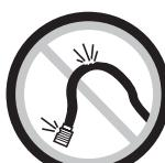
Les tuyaux souples peuvent causer de graves blessures. Vérifiez toujours les boyaux et les raccords et remplacez-les s'ils sont endommagés, fissurés ou lâches. Évitez d'utiliser un outil endommagé ou usé. Évitez d'utiliser des raccords rapides avec cet outil. Pour installer correctement l'outil, consulter les directives.
