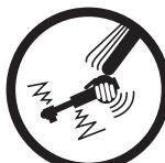
Les outils pneumatiques peuvent vibrer pendant l'utilisation. Une exposition prolongée aux vibrations, les mouvements répétitifs, ou une posture inconfortable lors de l'utilisation peuvent être nuisibles pour vos mains et vos bras. Arrêtez d'utiliser l'outil en cas d'inconfort ou si vous ressentez des picotements ou de la douleur. Consultez un médecin avant de recommencer à utiliser l'outil.
