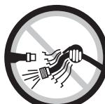
Avant d'installer, de retirer ou d'ajuster une pièce ou un accessoire, ou de faire l'entretien de l'outil, assurez-vous de toujours fermer la source d'alimentation en air, de purger l'air du boyau et de débrancher l'outil de sa source d'alimentation. Une négligence sur ce plan pourrait causer des blessures.
