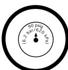
presión máxima de 90 psig (6.2 bar), utilizando una manguera de aire con un diámetro de 9.5 mm.
