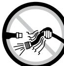
souples peuvent causer de graves blessures. Vérifiez toujours les boyaux et les raccords et remplacez-les s'ils sont endommagés, fissurés ou lâches. Évitez d'utiliser un outil endommagé ou usé. Évitez d'utiliser des raccords rapides avec cet outil. Pour installer correctement l'outil, consulter les directives.
