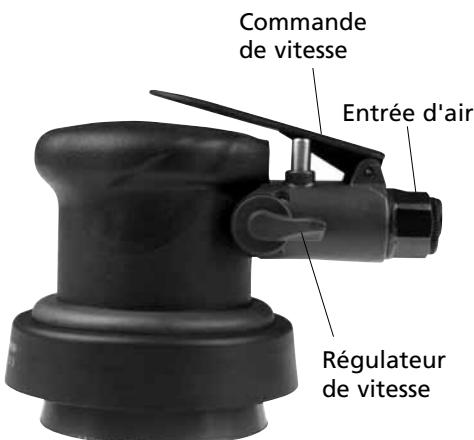
en air est raccordée à une entrée d'air ayant un filetage normalisé NPT de 1/4 po. Il faut augmenter la pression dans la conduite d'air dans le cas de boyaux à air exceptionnellement longs (plus de 25 pieds). Le diamètre intérieur minimal du boyau doit être de 3/8 po. Les raccords doivent avoir le même diamètre intérieur et être serrés solidement.
