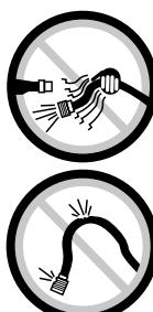
aire, vacíe toda la presión de aire de la manguera y desconecte la herramienta del suministro de aire antes de instalar, quitar o ajustar cualquier pieza o accesorio de esta herramienta, o antes de realizar cualquier mantenimiento de ella. Caso omiso en hacerlo podría ocasionar alguna
