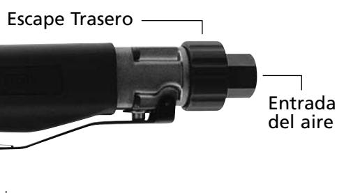
la presión en la línea para compensar por las mangueras de aire incomunmente largas (mayores de 25 pies). El diámetro mínimo de la manguera debe de ser de 3/8" de diámetro interior. Los herrajes deben contar con las mismas dimensiones y deben estar fijamente sujetados.
