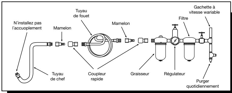
Les outils de cette catégorie fonctionnent avec un large éventail de pressions d'air. Nous recommandons une pression d'air à l'entrée de 90 lb/po<sup>2</sup>. Une faible pression (moins de 90 lb/po<sup>2</sup> ou de 6,2 bar) réduit la vitesse et le rendement de tous les outils pneumatiques. Une pression élevée (plus de 115 lib/po<sup>2</sup> ou 8,0 bar) excédant la puissance nominale de l'outil raccourcit sa durée de vie et peut causer des blessures.
