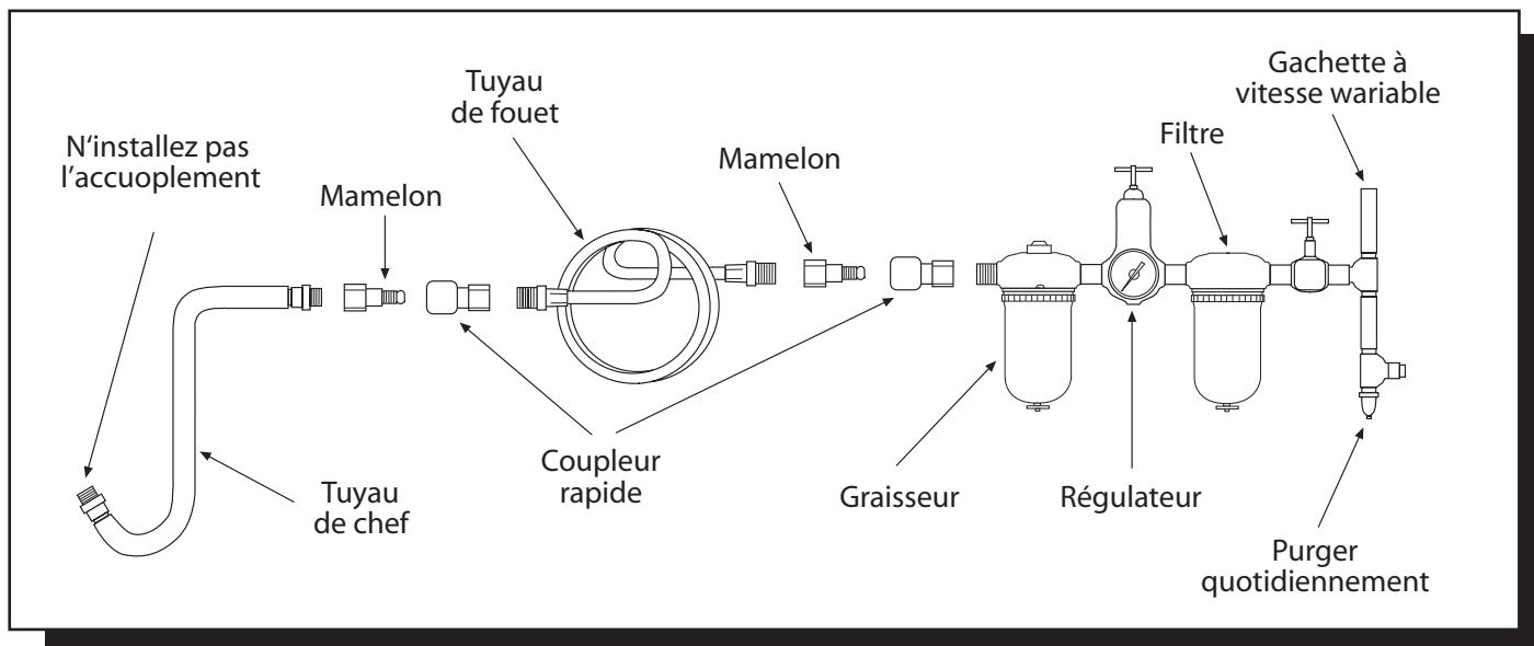
Les outils de cette catégorie fonctionnent avec un large éventail de pressions d'air. Nous recommandons une pression d'air à l'entrée de 90 lb/po<sup>2</sup>. Une faible pression (moins de 90 lb/po<sup>2</sup> ou de 6,2 bar) réduit la vitesse et le rendement de tous les outils pneumatiques. Une pression élevée (plus de 115 lib/po<sup>2</sup> ou 8,0 bar) excédant la puissance nominale de l'outil raccourcit sa durée de vie et peut causer des blessures.
