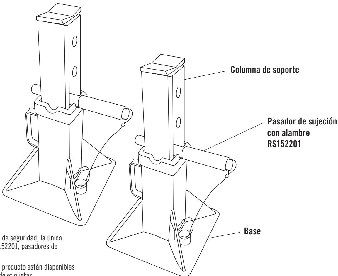
Debido a las precauciones de seguridad, la única parte reemplazable es RS152201, pasadores de sujeción con alambre.
