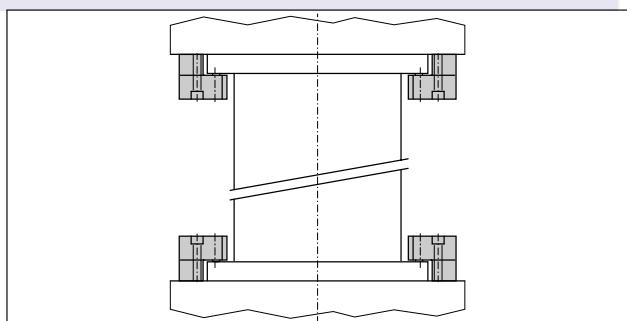
Die Spannleisten Typ MLC-604, MLC-906 und MLC-1208 bestehen aus einfachwirkenden Spannzylindern mit Federrückstellung. Sie wurden für das Spannen von Formen auf Preßtischen entwickelt und erreichen je nach Modell eine Spannkraft von 60, 90 oder 120 kN. Die Abmessungen sind laut Abbildung 2 auf Seite 13 zu entnehmen. Die Ölversorgungsanschlüsse (3) haben eine Größe von  $1/4"$  BSP.
