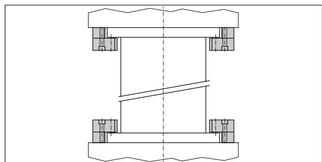
De manifolds met geïntegreerde plunjers model MLC-604, MLC-906 en MLC 1208 zijn enkelwerkend, veerretour. Ontworpen voor het blokkeren van stempels op vormpersen. Afhankelijk van het model, ontwikkelen deze manifolds een kracht van 69-90 kN of 120 kN. Voor de afmetingen zie illustratie 2 op blz. 13. De olieaansluitingen zijn 1/4" BSP.
