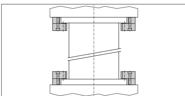
Les blocs collecteurs avec pistons intégrés (modèles MLC-604, MLC-906, MLC-1208) sont du type à simple effet avec ressort de rappel. Conçus pour le bridage de moules sur les plans des presses de moulage.
